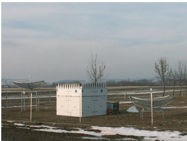
Abb. 20: links: RASS-System der Firma Metek in Kittsee (Foto: A. Kaiser); rechts: mobiles SODAR der Firma Metek zur Windmessung mit Solarpaneel zur Stromversorgung; Standort Innthal östlich von Innsbruck.
