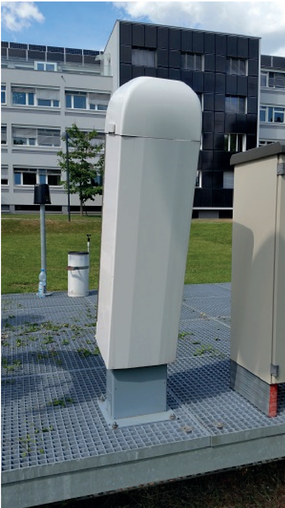
Abb. 26: Väisälä-Ceilometer CL51 am Gelände der ZAMG auf der Hohen Warte.
