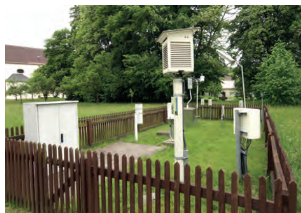
Abb. 9 Als Wettergarten eingezäunter Bereich im Konventgarten mit Ombrometer und genormter Wetterhütte für Thermometer, Taupunktmessgerät und Hygrometer
