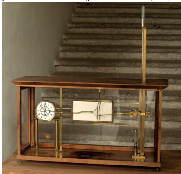
Abb. 5 Barograph nach Plänen von Karl Kreil, ging in Kremsmünster im August 1862 in Betrieb und stand bis 1947 in Verwendung, auch heute noch voll funktionsfähig
