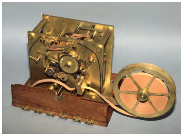
Abb. 6 Elektrisches Registriergerät für Windrichtung und -geschwindigkeit, in Betrieb genommen 1878
