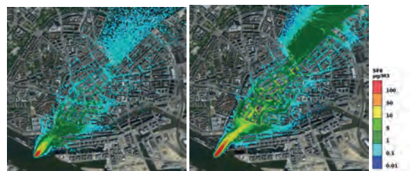
Abb. 10: Typ II Modellergebnis für CUTE Fall 1. Turbulenzparametrisierung; links mit höherer Turbulenz (TURB #1), rechts mit geringerer Turbulenz (TURB #2). Quelle: wie Abbildung 4 .
