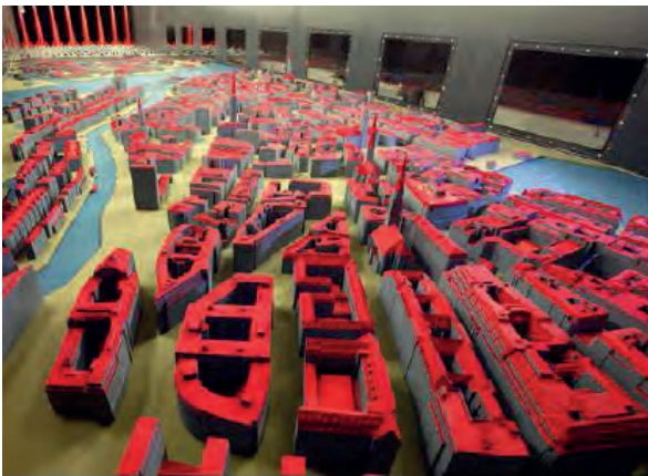
Abb. 9: Windtunnel-Modell des Zentrums einer typischen mitteleuropäischen Stadt. Quelle: wie Abbildung 4 .
