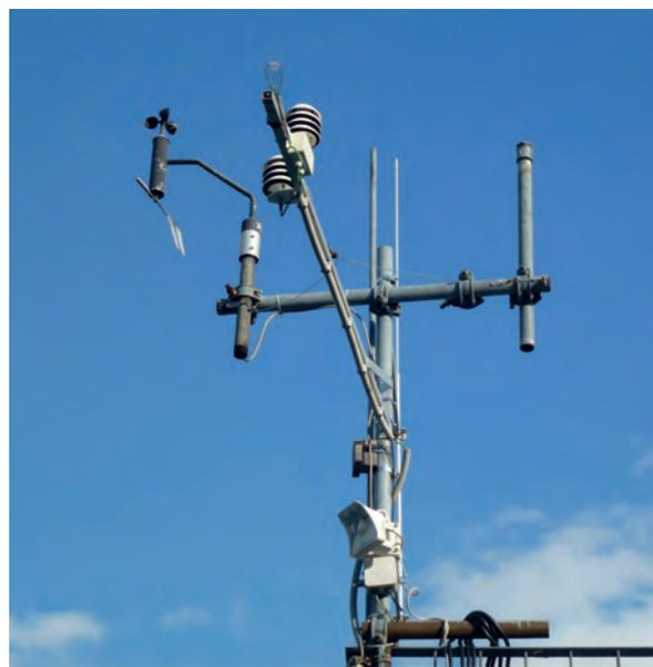
**Abb. 4:** Wetterstation und darunter Wetter-Webcam auf dem Schwackhöfer-Haus.
