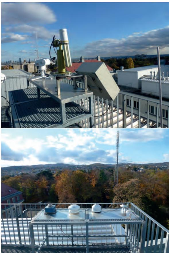
**Abb. 3:** Strahlungsmessungen auf dem Schwackhöfer-Haus: Es werden u. a. die optische Dicke der Aerosole, die direkte und die diffuse kurzwellige Strahlung sowie die atmosphärische Gegenstrahlung beobachtet. Eine Fischaugenkamera dient dem Monitoring der Bewölkung.
