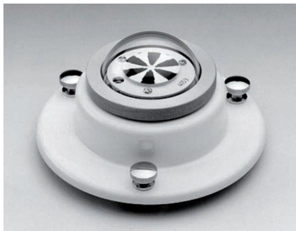
Abb. 1: Sternpyranometer nach Dirmhirn.
